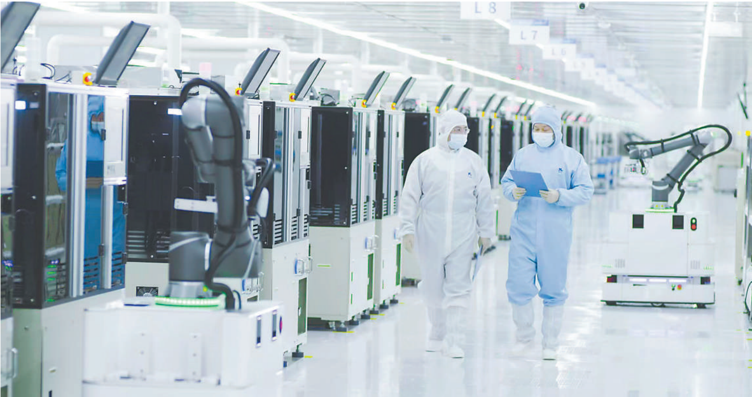
优艾智合晶圆搬运机器人,在半导体车间内实现晶圆高精度、稳定转运。
