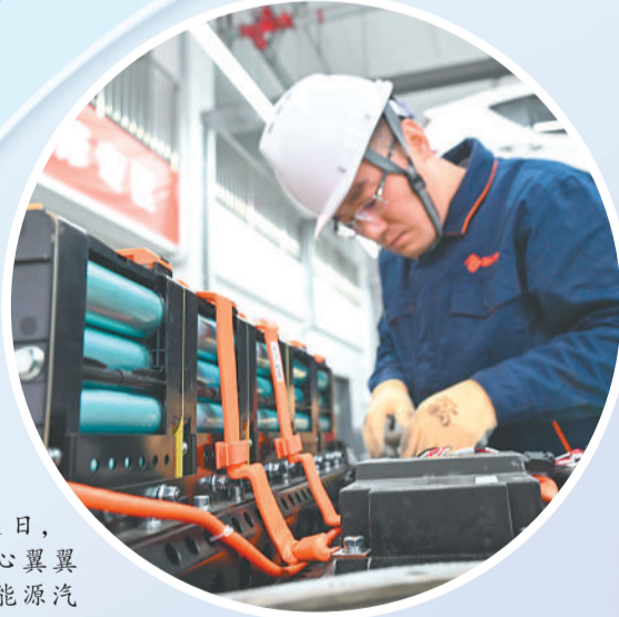
▶ 3月11日,钮友平(右)和同事在维修新能源汽车电池包,作为“电池医生”,需掌握高压安全、电池原理、BMS系统等相关知识。
