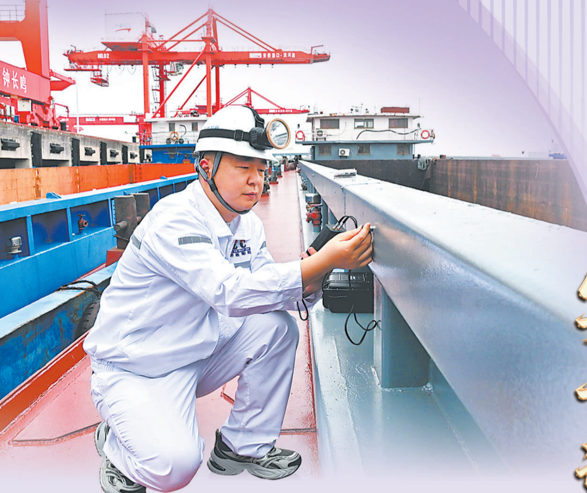
▲ 4月27日,合肥派河港码头的货船上,饶春彬使用测厚仪检验船舶钢板。
