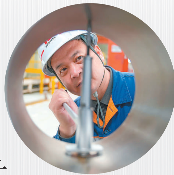
► 4月23日,马钢交材车轮精加工车间,沈飞在检查车轮口直径抗压度。
