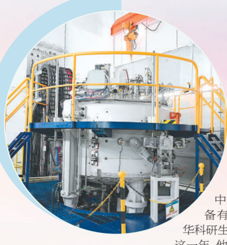
4月13日拍摄的合肥中科离子医学技术装备有限公司研发的首台超导回旋质子加速器。 本报记者 徐昊 摄
