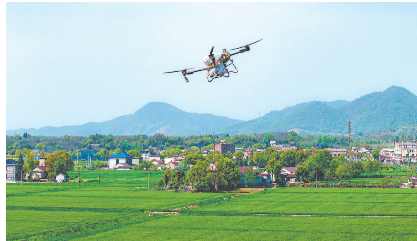
芜湖市繁昌区平铺镇，无人机飞手正在使用植保无人机进行小麦春管作业。
