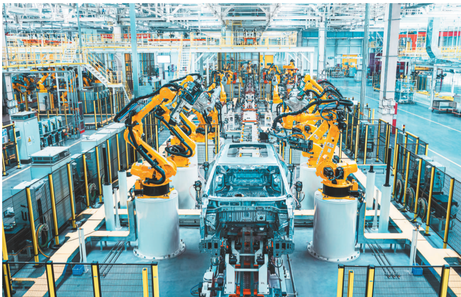
奇瑞集团搭建“关键技术平台+超级智能工厂”一体化研发体系，提供一站式检测认证服务。图为奇瑞焊装生产线。 吴宣 摄
