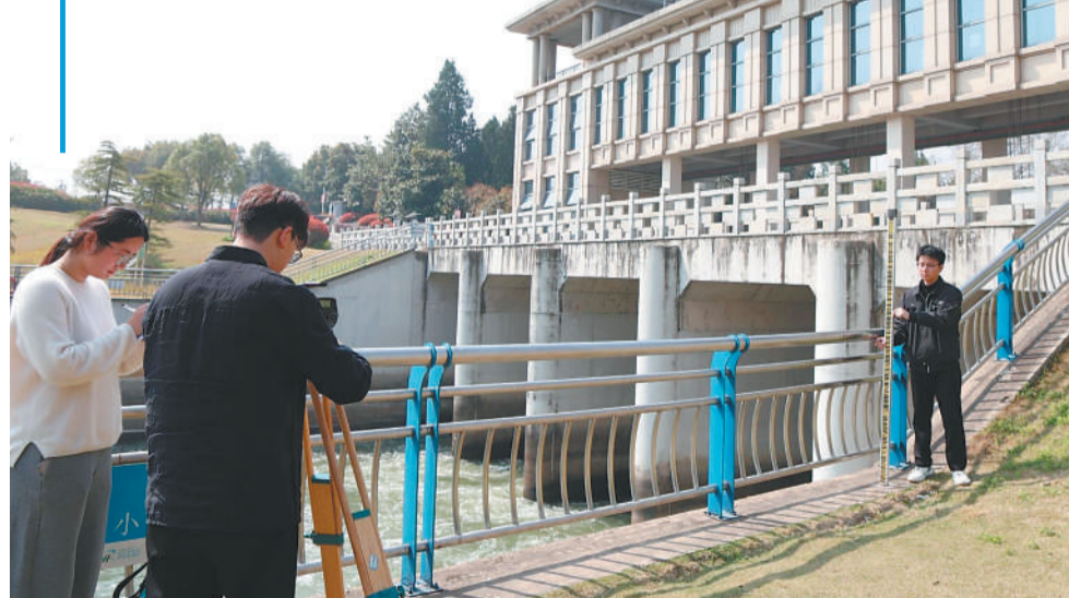
3月25日，安徽省史书杭灌区淮河总干渠三十铺分局工作人员对罗管节制闸开展水闸垂直位移观测工作，筑牢汛前安全防线。 本报通讯员 蒋彩虹 摄
