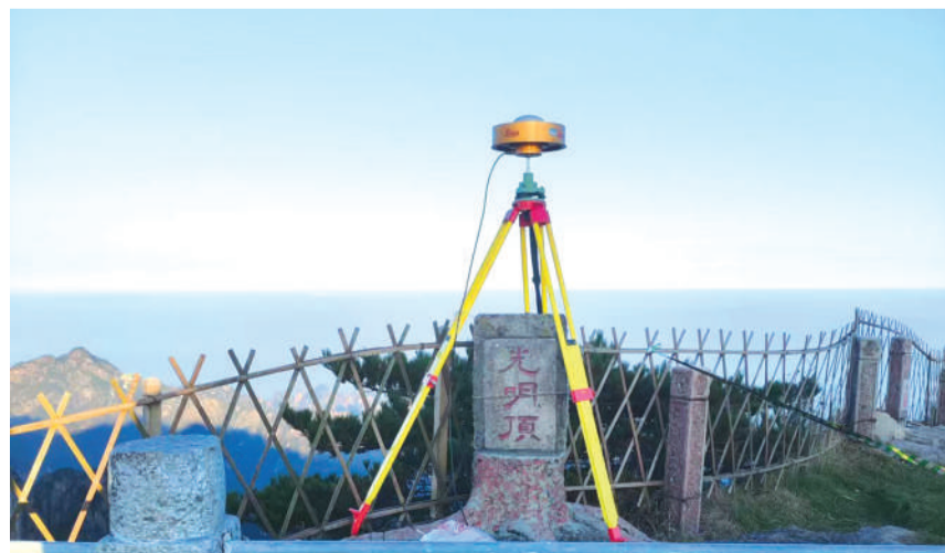
安徽省第三测绘院开展GNSS点外业观测工作。
