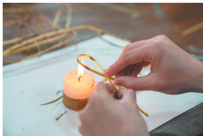
黄观豪用蜡烛烘烤细竹篾,以提高毛竹柔韧度,便于绑扎灯彩骨架。
