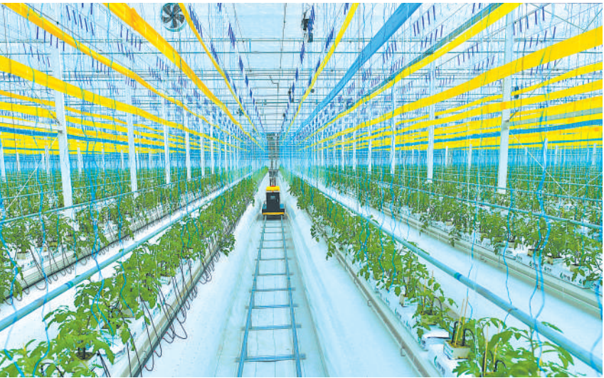
10月11日,合肥市包河区大圩镇的数字化种植工厂里,全自动设备在对番茄进行植保。当地通过立体种植、空气调配、作物补光、水肥一体化自动控制等技术,让大棚内充满了“科技范”。据了解,该工厂种植面积约2.2万平方米,采用无土栽培小番茄供应合肥及周边市场。 本报记者 程兆 摄
