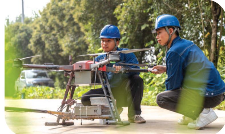
近日,在六安市金安区中店乡10千伏黄泥店109线秋检现场,国网六安供电公司工作人员以不停电作业方式,利用无人机喷涂技术对开关在运桩头、大档距裸导线进行绝缘喷涂和质量评价。目前,该公司无人机技术广泛应用于输配电线路巡检中,有效推动了从传统人工作业向信息化、智能化作业转变。李宏提 许滨 摄
