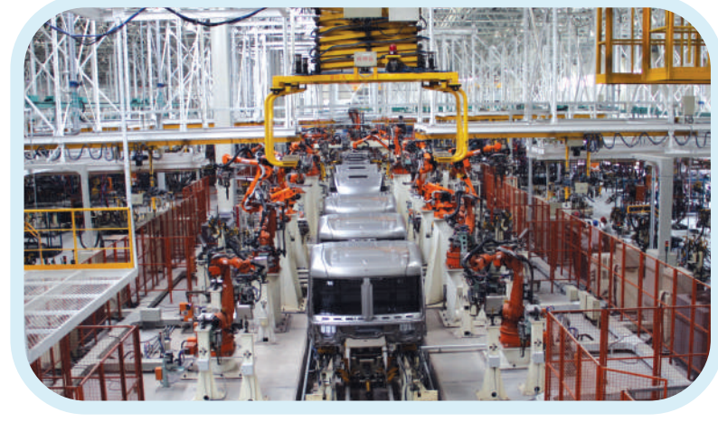
汉马科技新能源商用车生产基地全自动机器人焊装生产线。谢昌林 摄
