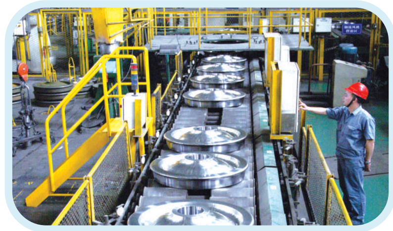
马钢交材快速客车辗钢整体车轮生产线。汤金春 摄
