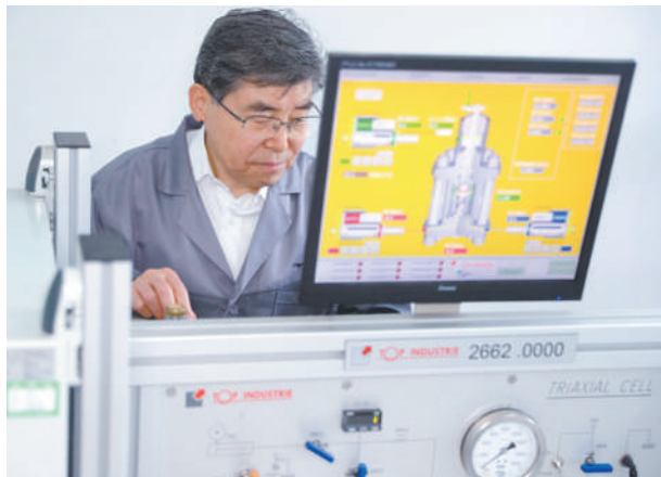
王运敏在岩石力学实验室开展岩石三轴力学实验。
