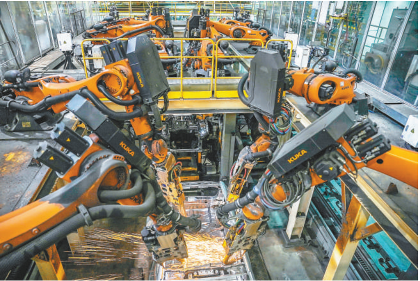
在合肥市蜀山区一家汽车制造企业的自动化组装焊接生产线上,智能机械臂正在进行车辆框架焊接组装。 本报通讯员 葛庆钊 摄
