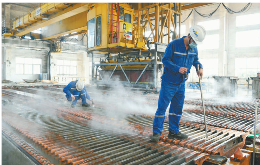
1月28日,工人在铜陵有色金隆铜业公司电解车间生产电解铜。 本报通讯员 过仕宁 摄
