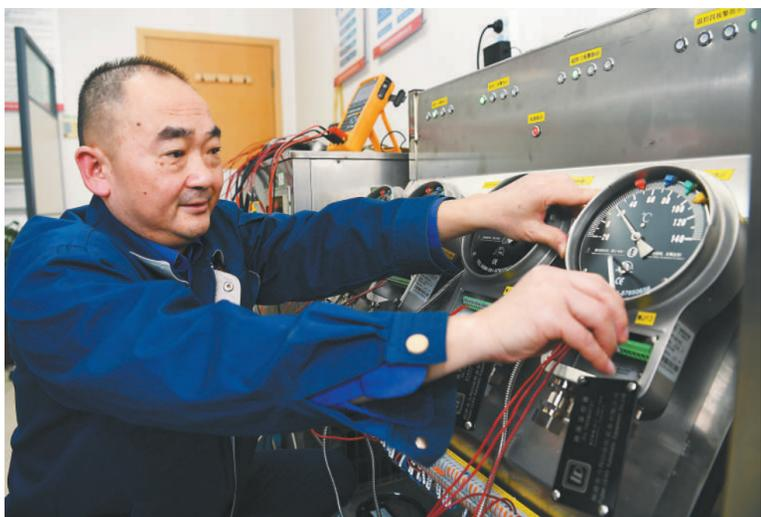
◀ 2022年10月10日,中能建建筑集团有限公司热工仪表控制首席技师杨秀忠使用自主研发的变压器油面温度控制器进行检测工作。
