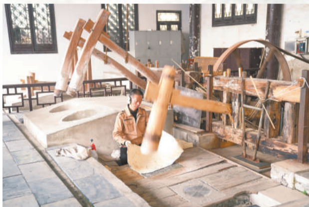
破皮工序是个漫长的过程，需要用大木锤反复春捣、打压，直至皮草能够黏合成粗糙的皮纸。
