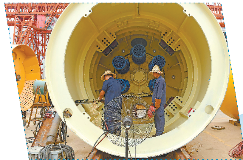
唐兴机械装备有限公司生产的顶管掘进机广泛应用于污水、燃气、电力等地下管网铺设。
