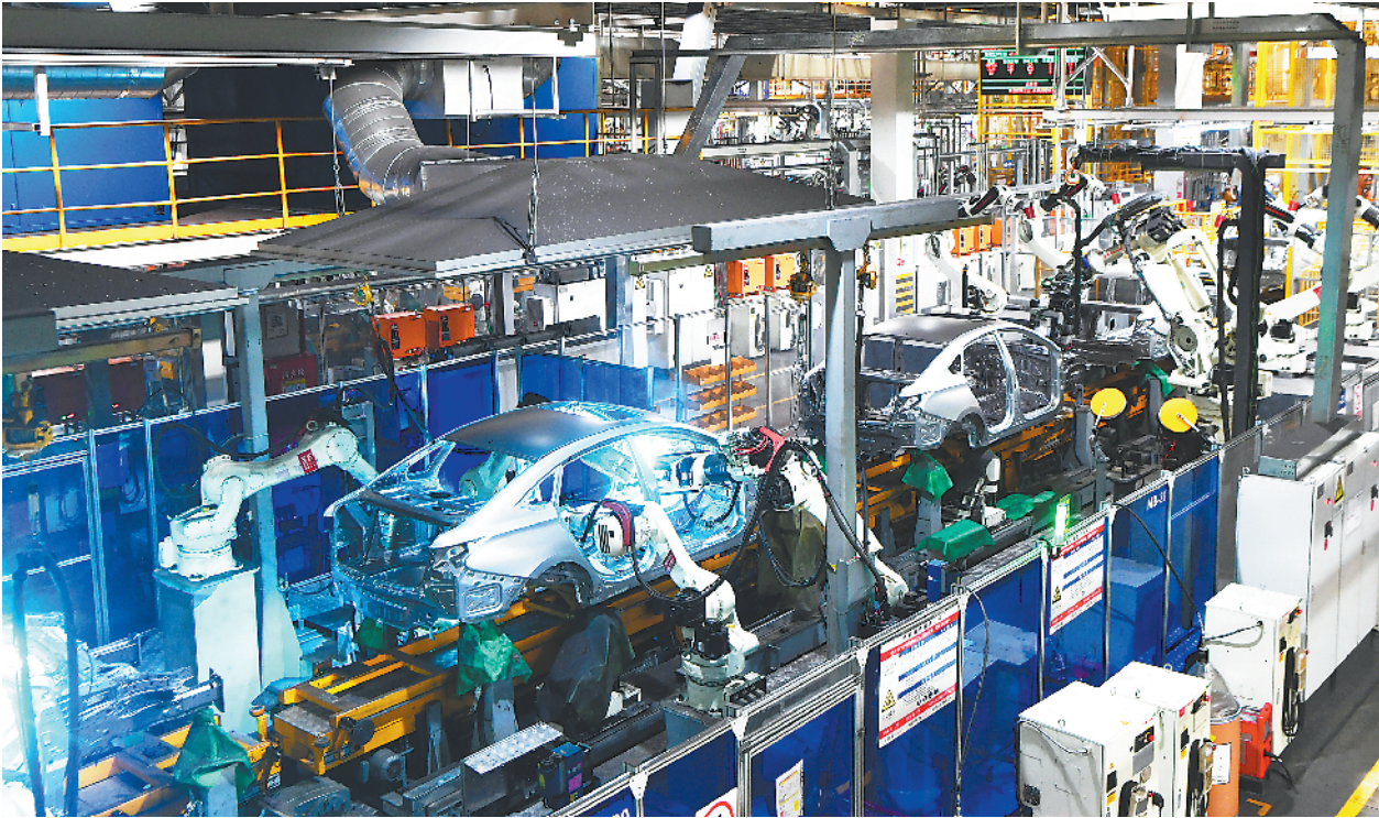
在重庆两江新区的长安汽车两江智能工厂，工业机器人在焊接车间的流水线上作业(2020年7月21日报)。 新华社发
