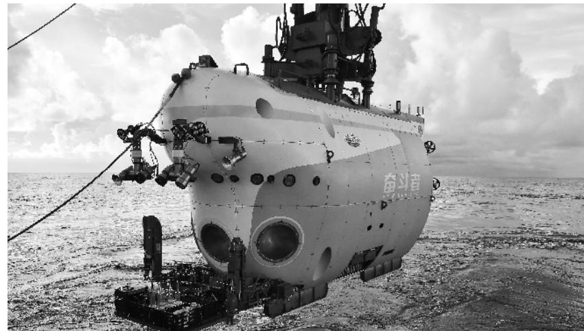
“奋斗者”号在西太平洋即将入水(9月1日摄)。我国自主研发的全海深载人潜水器“奋斗者”号,近日已在马里亚纳海沟正式投入常规科考应用。在马里亚纳海沟“挑战者深渊”下潜作业期间,“奋斗者”号开展了利用深侧扫设备进行目标搜寻及地形探测、采集深海海底沉积物、岩石和生物样本、搭载沉积物保压取样装置海试等作业任务。
