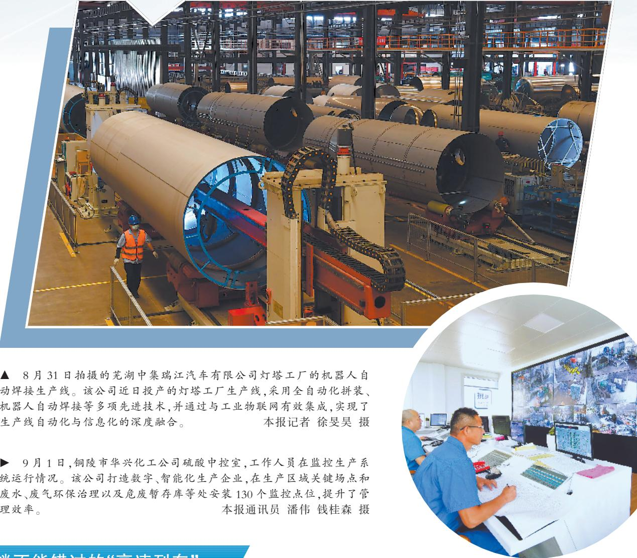
▲ 8月31日拍摄的芜湖中集瑞江汽车有限公司灯塔工厂的机器人自动焊接生产线。该公司近日投产的灯塔工厂生产线，采用全自动化拼装、机器人自动焊接等多项先进技术，并通过与工业物联网有效集成，实现了生产线自动化与信息化的深度融合。
