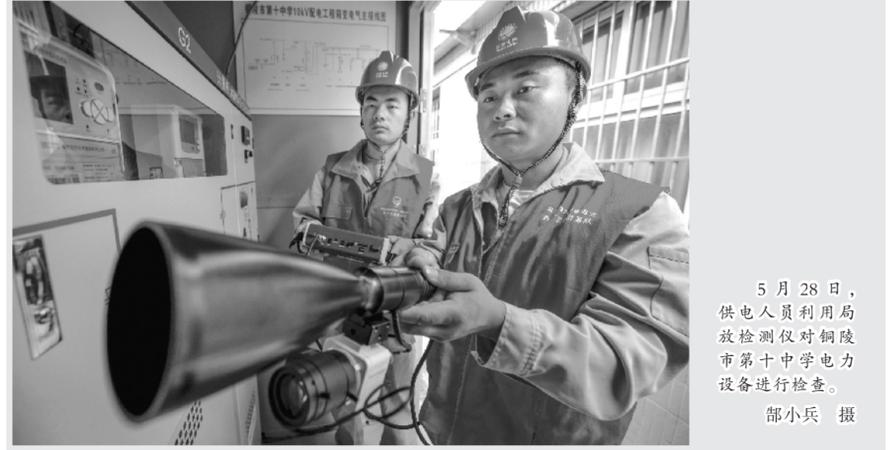
5月28日,供电人员利用局放检测仪对铜陵市第十中学电力设备进行检查。
