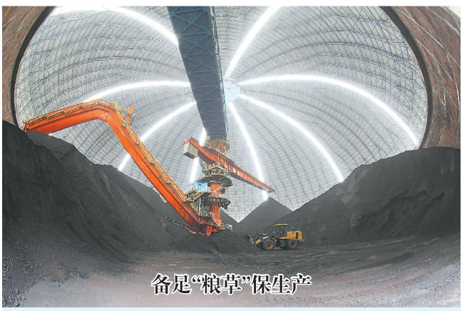
3月10日,中安联合原料煤仓堆取料机在进行配煤作业,为煤气化装置提供生产原料。截至2月底,中安联合煤化工 装置保持高负荷稳定运行,超额完成月度生产任务。目前,原料煤、动力煤库存达19万吨,备足了煤化工生产的"粮草",为 装置高负荷运行打下坚实基础。 本报通讯员 赵天奇 摄
